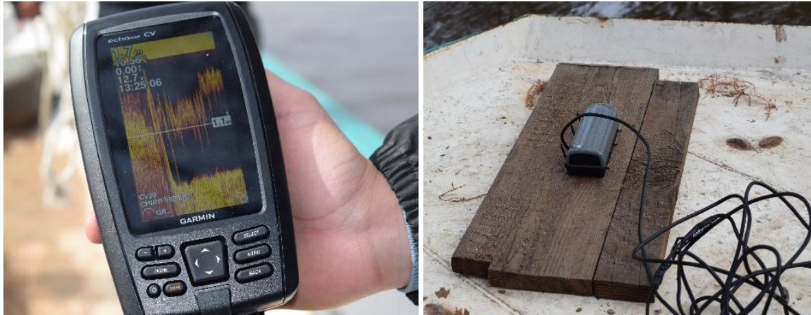
Figura 2.34. Ecosonda ECHOMap GARMIN modelo 42cv, controladora (izq.) y sonda (der.)
