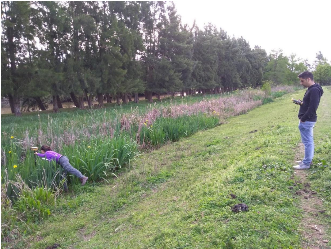
Figura 2.18. Relevamiento RTK con GPS diferencial
