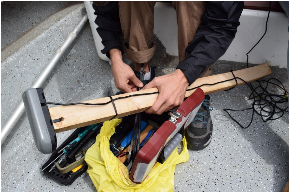
Figura 2.48. Trasductor de ecosonda con dispositivo de sostén.
