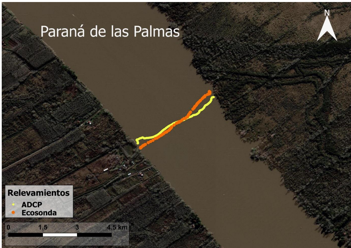
Figura 2.57. Sección relevada por dispositivos ADCP y Ecosonda
