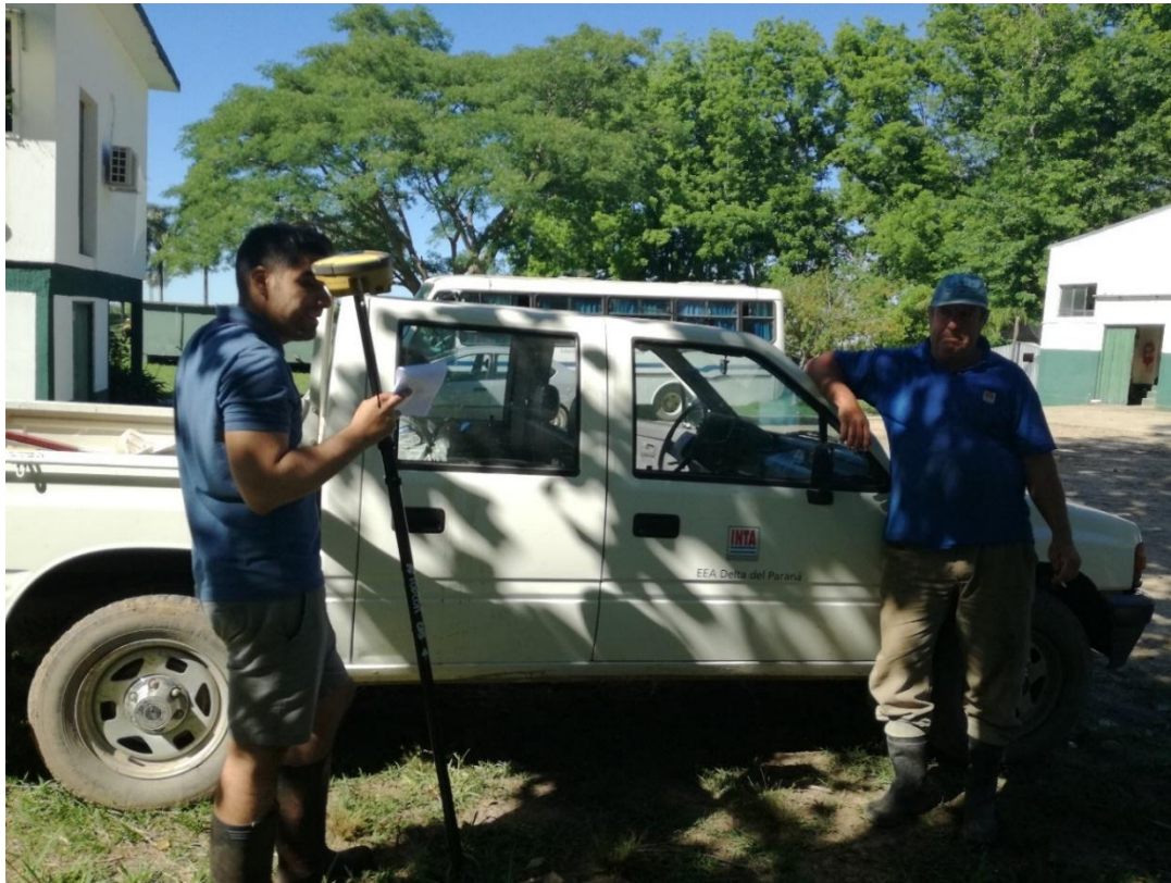
Figura 2.23. Relevamiento en vehículo con RTK.
