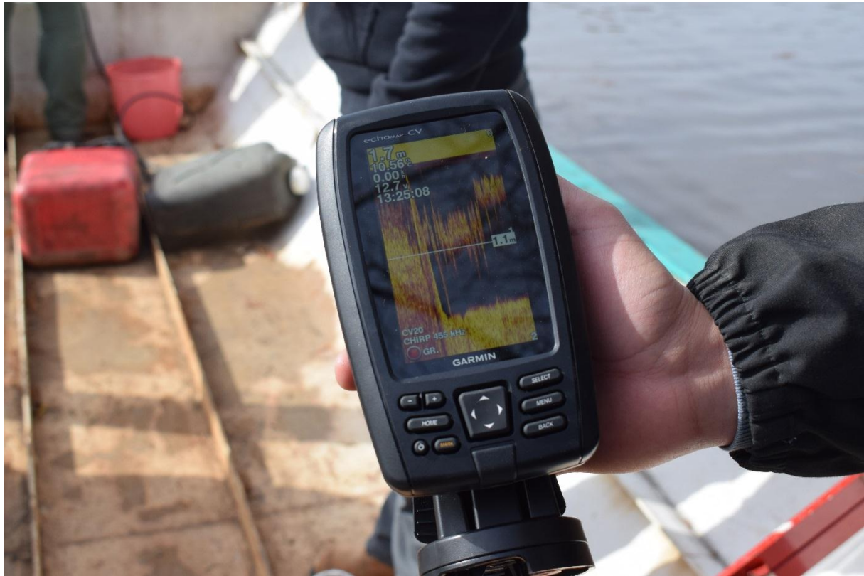
Figura 2.39. Controladora de la ecosonda midiendo batimetría.
