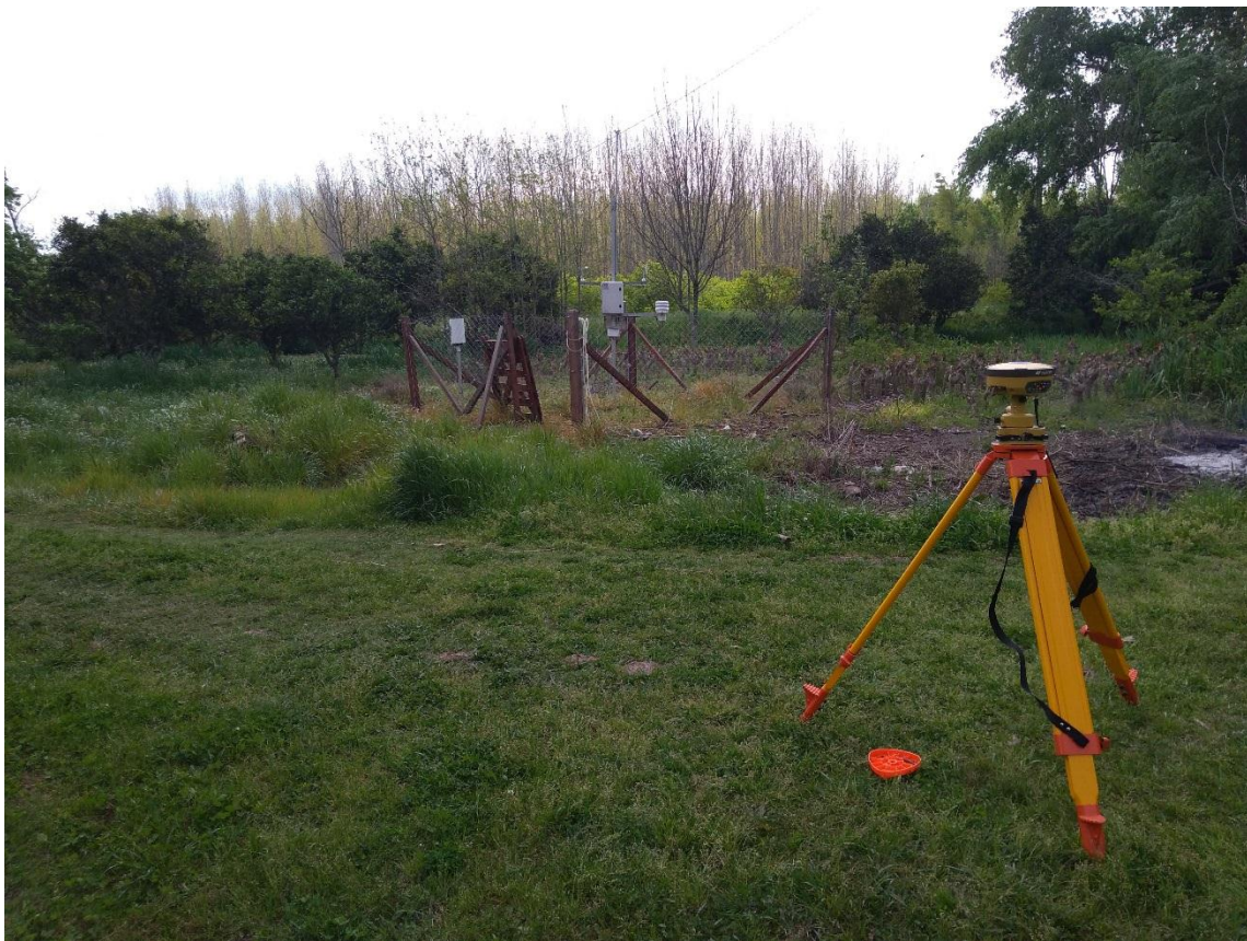
Figura 2.17. Estación base GPS Diferencial
