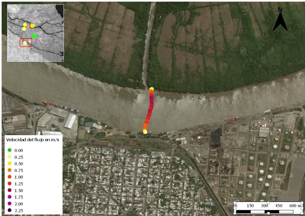
Figura 2.24. Velocidades promedio de la sección aforada (Paraná de las Palmas)
