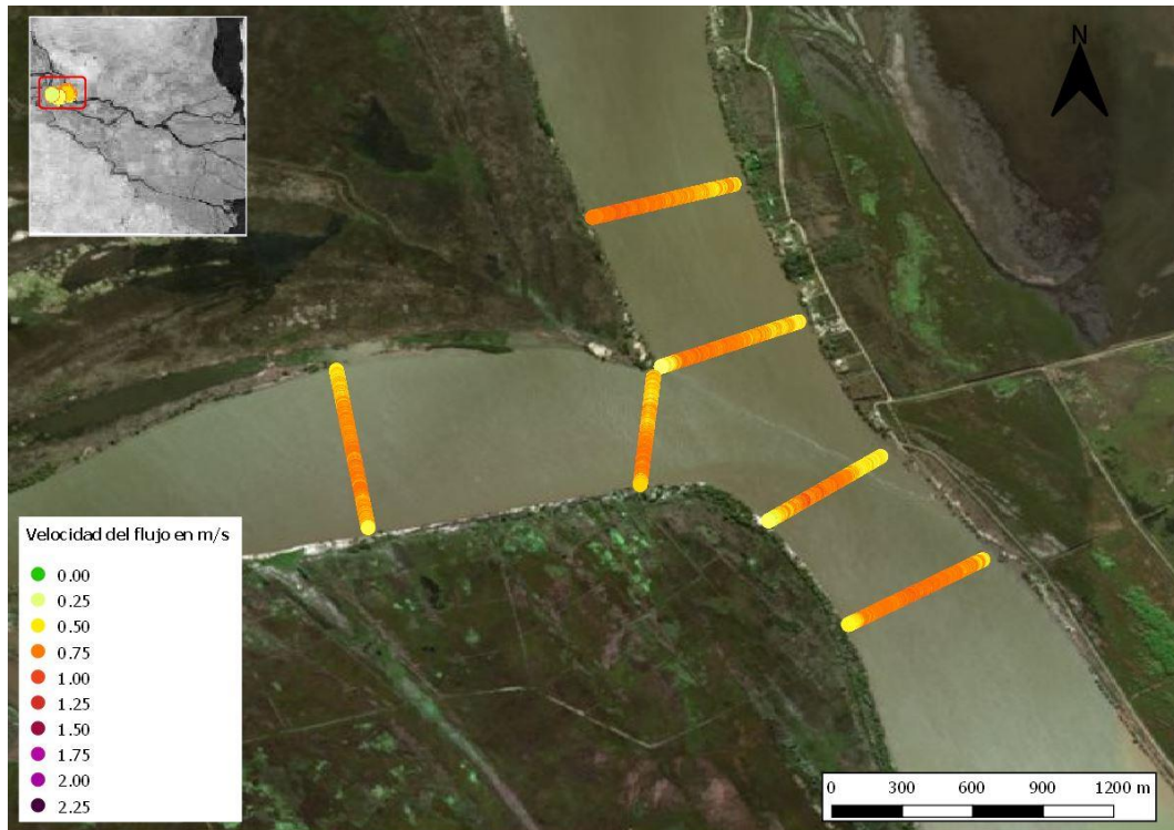
Figura 2.65. Velocidades promedio de las secciones aforadas (Paraná Guazú – Paraná Ibicuy).
