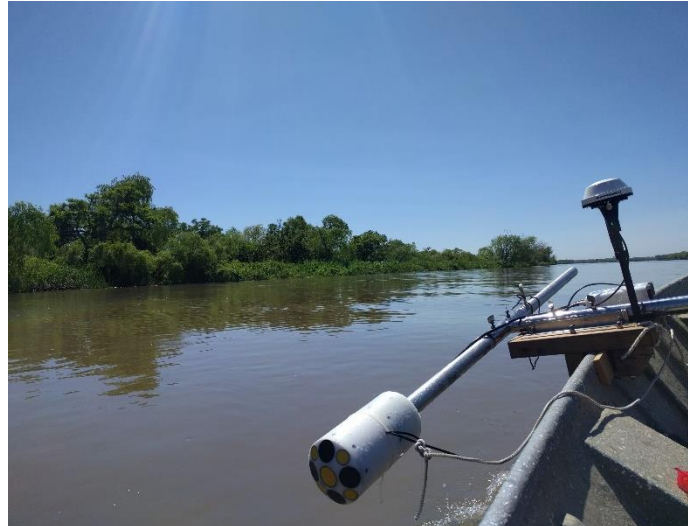
Figura 2.1. Perfilador de corriente acústico Doppler utilizado (ADCP).
