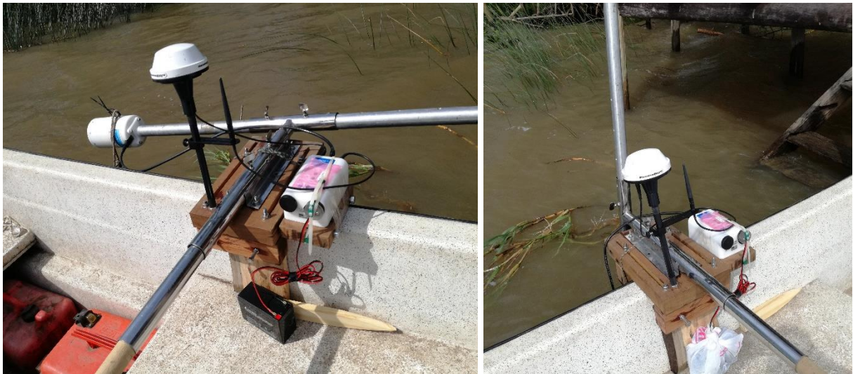
Figura 2.3. Dispositivo de sostén del ADCP y accesorios en posición de medición y traslado.
