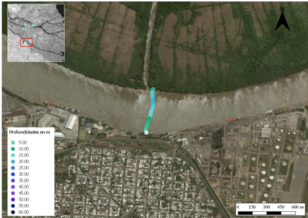
Figura 2.19. Batimetría de la sección aforada (Paraná de las Palmas).
