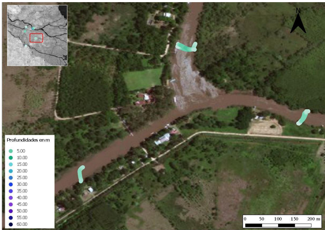
Figura 2.20. Batimetrías de las secciones aforadas (Canal Alem y Arroyo Carabelas Grande).
