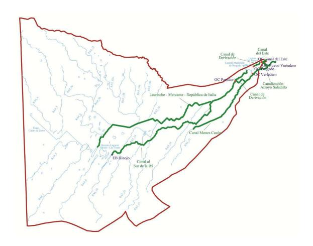
Figura 6.4.1. Obras hidráulicas en la subregión A3/A4 (CA: canalización; OC: obra de control).
