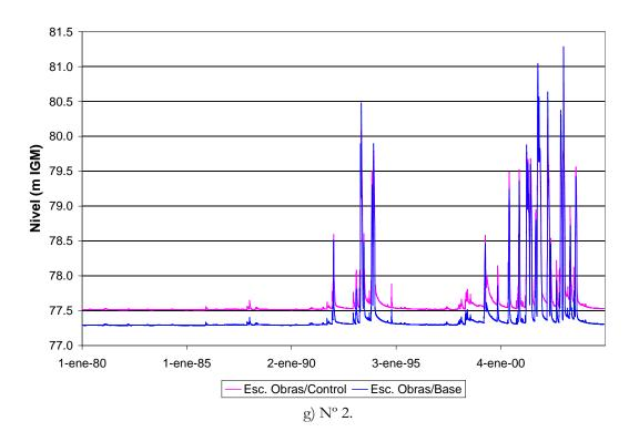
**Figura 6.2.23.** Nivel de agua en la sección de aguas arriba de pequeñas obras de control para el escenario Obras/Control.
