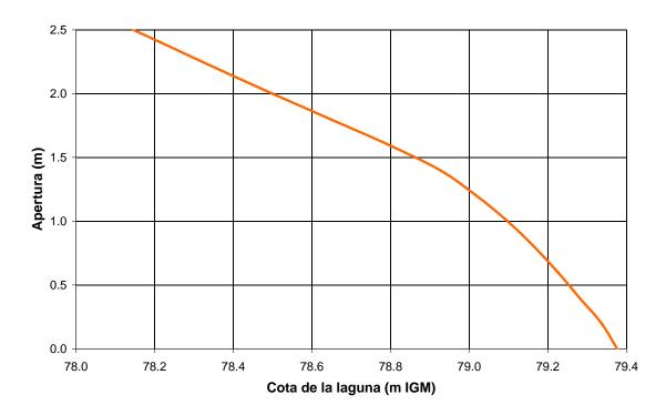
**Figura 6.2.6.** Ley de apertura de las compuertas para mantener un caudal de 135 m³/s por Mar Chiquita.
