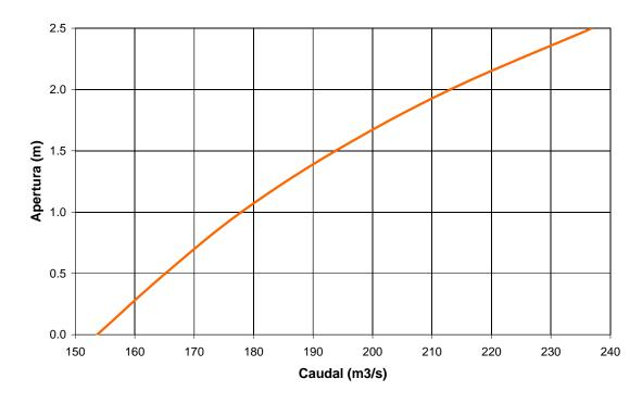
**Figura 6.2.7.** Ley de apertura de las compuertas para mantener un nivel de 79,5 m IGM en Mar Chiquita.
