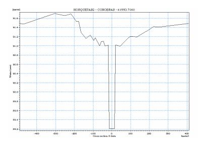
Figura 6.1.1. Sección transversal canalizada de Horquetas 2.
