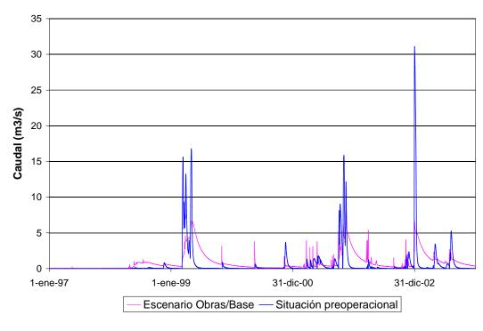
Figura 6.2.12. Caudal en sección de aguas arriba de Horquetas 2 para el escenario Obras/Base.
