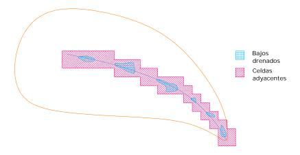
**Figura 6.1.2.** Esquema de celdas afectadas en su abstracción inicial por la construcción de drenajes de bajos.
