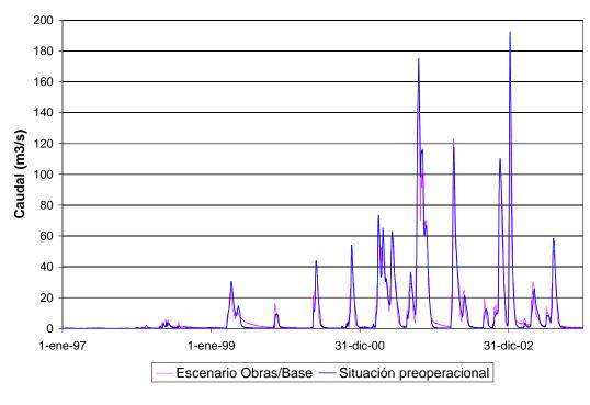
Figura 6.2.14. Caudal en sección de aguas abajo de Horquetas 1 para el escenario Obras/Base.
