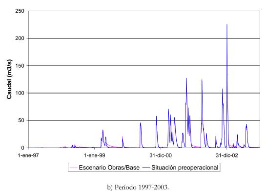
Figura 6.2.13. Caudal en sección de aguas abajo de Horquetas 2 para el escenario Obras/Base.
