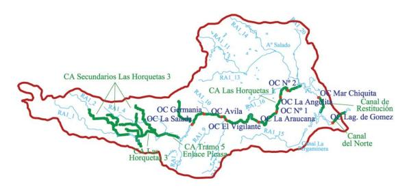
Figura 6.2.1. Obras hidráulicas en la subregión A1 (CA: canalización; OC: obra de control).
