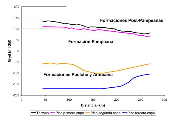
Figura 3.1.3. Perfiles longitudinales de las capas hidrogeológicas para la subregión A1.
