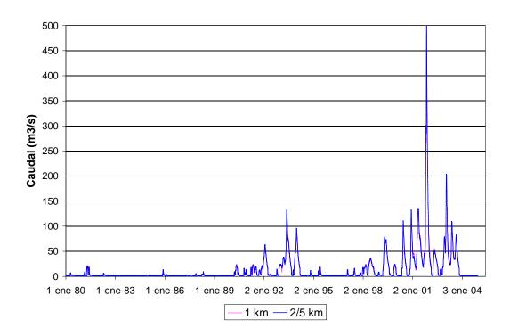
Figura 4.2.14. Caudal en Junín variando el espaciamiento entre secciones de las conducciones.
