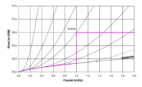
**Figura 6.2.8.** Ley 'atractora' (línea morada) para la política de operación del sistema de compuertas de la laguna de Mar Chiquita para aguas bajas.
