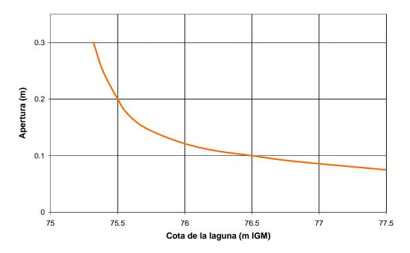
**Figura 6.2.9.** Ley de apertura de la primera compuerta para mantener un caudal de 1 m³/s por Mar Chiquita.
