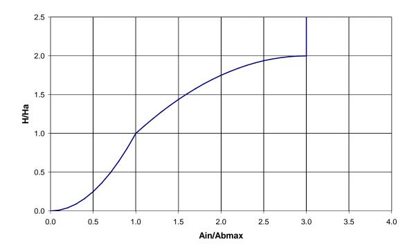
Figura 5.4.1. Ley de variación del área inundada en función de la altura de inundación.
