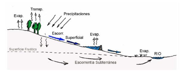
Figura 2.1.1. Esquematización de procesos modelados.
