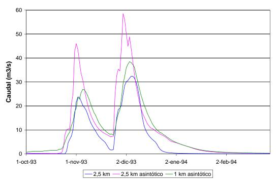
**Figura 4.2.18.** Serie de caudales al pie del ramal RA1\_S8 con modelos de distinto paso y para distintos descensos.
