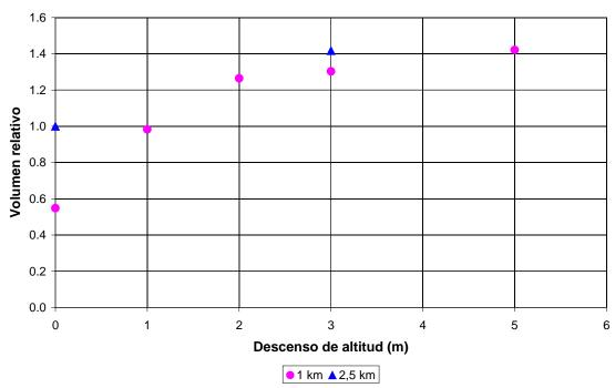
**Figura 4.2.17.** Volumen escurrido al pie del ramal RA1\_S8 con modelos de distinto paso y para distintos descensos.
