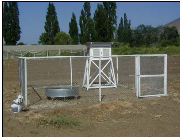
Figura 13. Bandeja de Evaporación Clase A (USWB).
